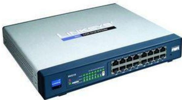
**GATEWAY (PURTA DE ENLACE):** es un dispositivo con frecuencia un ordenador, que permite interconectar redes con protocolos y arquitecturas diferentes a todos los niveles de comunicación. Su propósito es traducir la información del protocolo utilizado en una red al protocolo usado en la red del destino.
